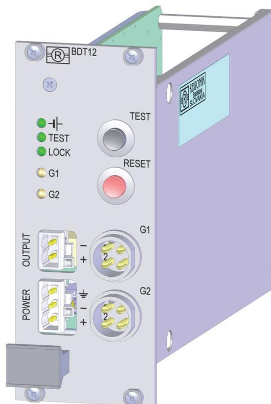
Ak vozidlo stojí, je možné vykonať test blokovania dverí. Test sa spustí stlačením tlačidla *TEST* na prednom paneli BDT12. Rozsvietia sa LED *TEST* a *LOCK* oranžovým svetlom. Po dobu jednej minúty budú dvere vozidla zablokované. Po uplynutí jednej minúty od začiatku testu sa dvere odblokujú a zhasnú LED *TEST* a *LOCK*. Test je možné predčasne zrušiť tlačidlom *RESET*.
